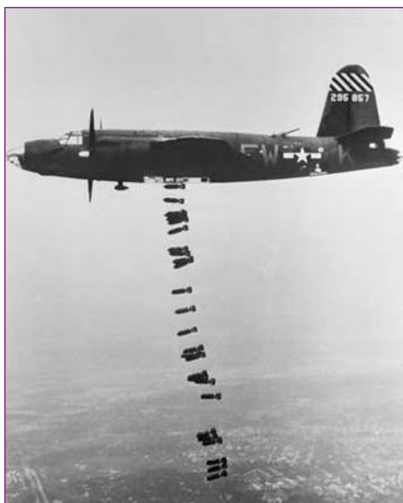
Afbeelding 4. Voorbeeld van een B-26 Marauder bommenwerper uit de Tweede Wereldoorlog. Deze werpt 100 lb. bommen. 3
